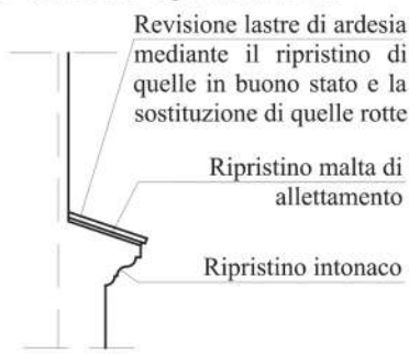
Post Operam Ripristino cornicioni e copertine di ardesia
